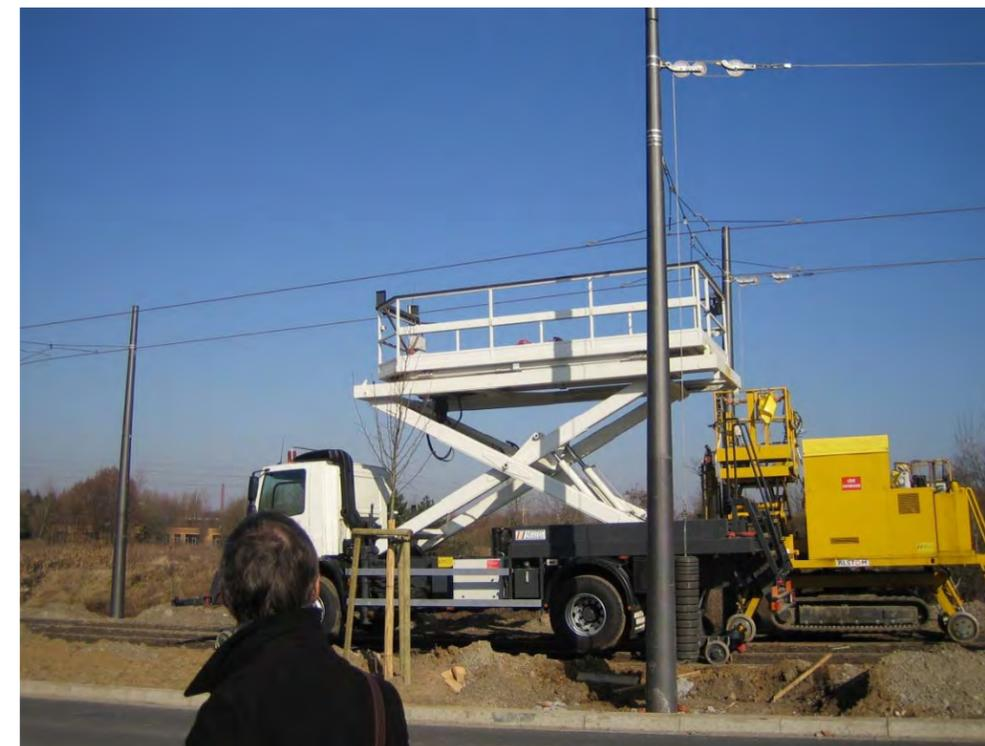
Figure 27 : Photo d'un camion rail/route avec nacelle de grandes dimensions
